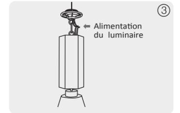
Faites descendre le luminaire pour compléter le branchement électrique du luminaire.
